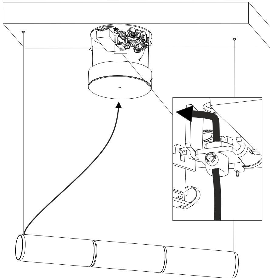
步骤4c/ 请将电线连接到夹具上。
