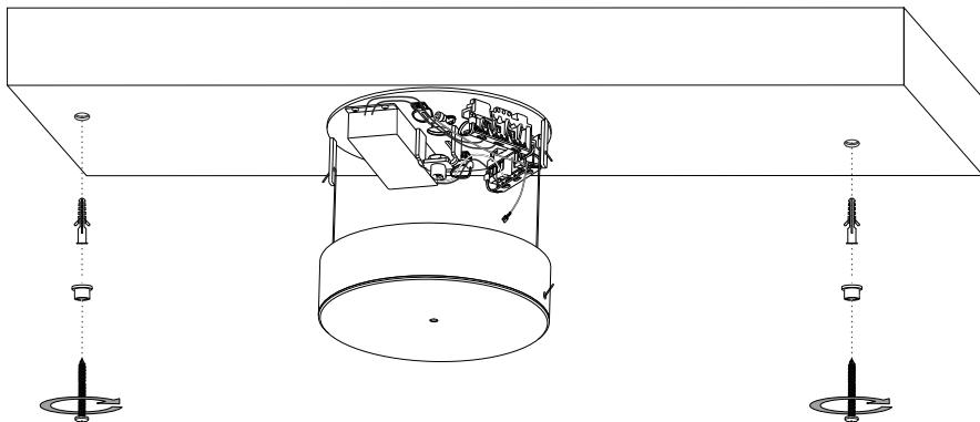
步骤3b/ 请将电缆夹旋入准备好的电缆夹座内。
