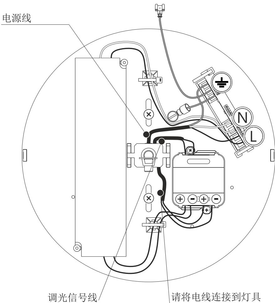
步骤4d/ 请利用螺钉固定。请注意不要损坏电线。
