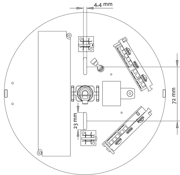
步骤2d/ 请裁剪出吸顶盖和玻璃组件所需的开孔。
