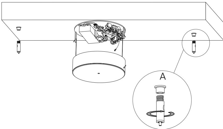
步骤3c/ 请悬挂玻璃组件。请按照图片所示利用电缆夹固定电线。
