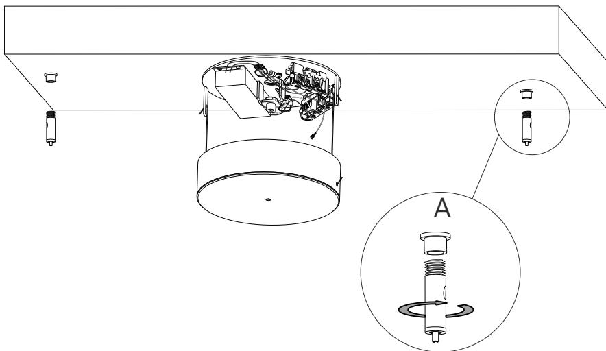
단계 3c) 유리 부품을 매달아 주십시오. 그림과 같이 케이블 클립을 이용하여 전선을 고정해 주십시오. 그림과 같이 케이블 클립을 이용하여 전선을 고정해 주십시오.
