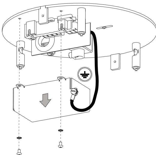
步骤4c/ 将带光源的总成放入玻璃中。
